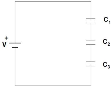
Come deve essere il **condensatore equivalente**? Esso dovrà avere carica  $q$  (la stessa di tutti i condensatori) e ddp pari alla somma delle ddp.
