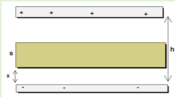
All'interno di un condensatore le cui armature distano  $h$ , viene inserita una lastra dielettrica (costante dielettrica relativa  $k$ ) di spessore  $s < h$ , avente la stessa area delle armature del condensatore. Calcolare la capacit  del condensatore.
