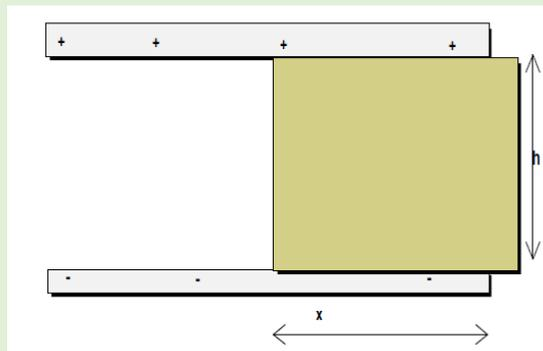
Supponiamo di cominciare ad inserire una lastra dielettrica che tutto lo spessore  $h$  del condensatore piano, ma questa volta abbiamo iniziato ad inserire il dielettrico solo di un tratto  $x$ . Calcolare la forza  $F$  con cui la lastra   risucchiata tra le armature quando il condensatore   mantenuto collegato ad un generatore di d.d.p. costante  $V$  tra le armature.
