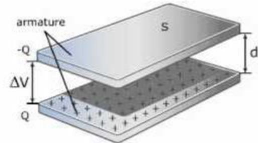
Il condensatore si dice essere carico se le sue armature sono cariche con la stessa carica ma di segno opposto.
