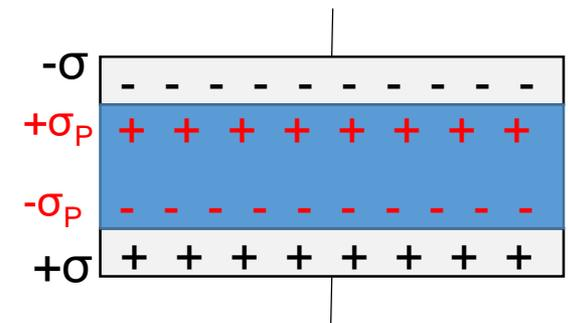
che ci indica che nel dielettrico si sommano i campi dovuti alle cariche sulle armature ( $E_0$ ) e quelle dovute alle cariche nel dielettrico ( $\frac{\sigma_P}{\epsilon_0}$ ) e ci indica la relazione tra le cariche nel dielettrico dovute alla **polarizzazione** e le cariche sulle armature.
