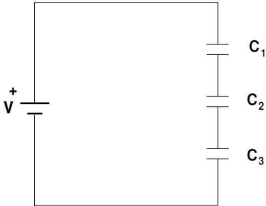
I condensatori sono in serie quando la differenza di potenziale  $V$  è applicata all'insieme di tutti i condensatori e su ciascuno di essi vi è la stessa carica  $q$ . La differenza di potenziale (ddp) è in questo caso la somma delle ddp di ciascun condensatore.
