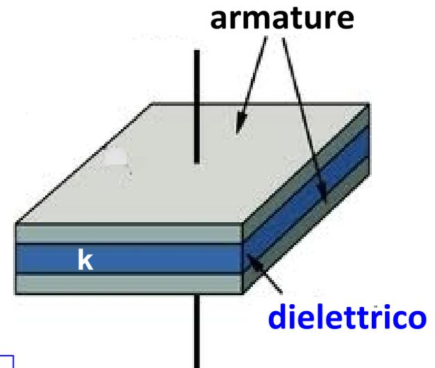
Inoltre ogni materiale ha un valore massimo di differenza di potenziale che si può applicare superato il quale il materiale viene perforato da una scarica elettrica. A questo valore di potenziale corrisponde un massimo valore di campo elettrico detto **rigidità dielettrica**.
