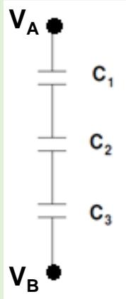
3 condensatori sono collegati in serie con una d.d.p. complessiva ai capi della serie pari a  $V_B - V_A = 100$  V ed una capacità equivalente della serie pari a 100 pF. Calcolare i 3 valori  $C_1$ ,  $C_2$ ,  $C_3$  affinché tra  $V_A$  e  $C_1$  vi siano 50 V e tra  $V_A$  e  $C_2$  vi siano 70 V.
