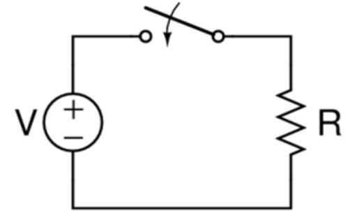
Consideriamo ora il pi`u semplice circuito che si ottiene collegando i poli del generatore con un resistore. Avremo ai capi del resistore la [legge di Ohm](#):
