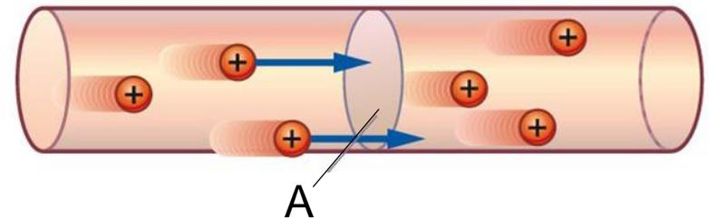
Vediamo adesso quanta carica è passata attraverso un elemento di conduttore infinitesimo generico di sezione infinitesima  $dA$  e lunghezza  $L$ , inclinato di un angolo  $\theta$  rispetto alla velocità di deriva  $\vec{v}_d$  (o campo elettrico):
