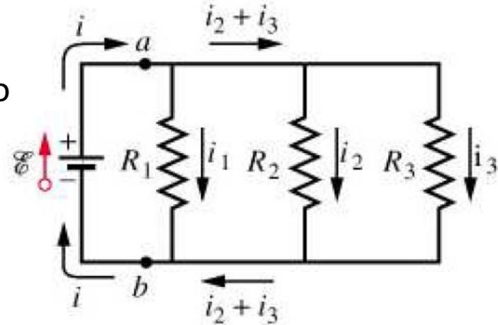
Per il principio di conservazione della carica, la corrente totale  $i$  erogata dalla pila deve essere pari alle correnti che attraversano le singole resistenze:
