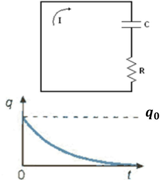
e derivando l'espressione si trova la corrente  $i(t) = \frac{dq}{dt} = - \frac{q_0}{RC} e^{-\frac{t}{RC}}$
