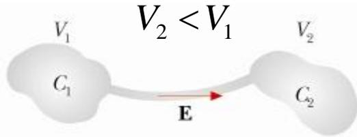
Si mettono in collegamento due conduttori carichi isolati a potenziali. Sotto l'azione del campo  $E$  si ha un flusso di elettroni
