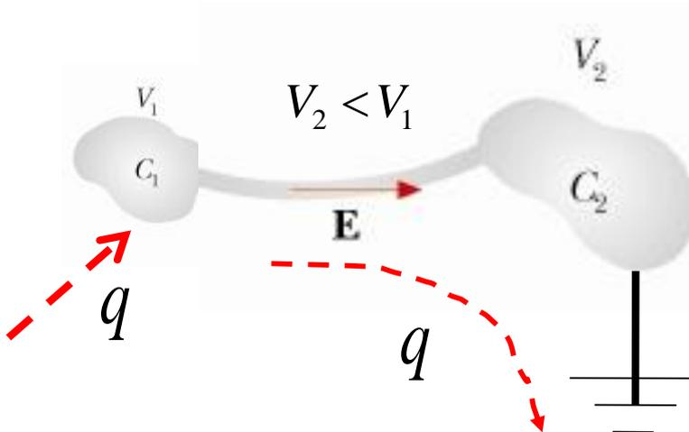
Se si mantiene una differenza di potenziale (d.d.p.) fra i conduttori, si instaura una **CORRENTE ELETTRICA**
