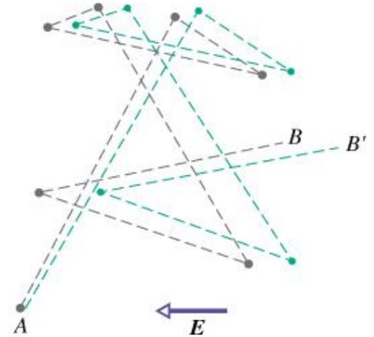
Per l'azione del campo  $\mathbf{E}$  le cariche positive si muovono con una velocità di deriva  $v_d$  e la carica totale dei portatori presenti è pari alla densità di cariche per unità di volume per il volume cioè  $nAL$  e la carica totale nel conduttore è  $q=nALe$ , quindi
