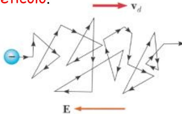
Nell'intervallo di tempo che intercorre tra due urti successivi, un elettrone di conduzione si muove effettivamente di moto uniformemente accelerato, con accelerazione:
