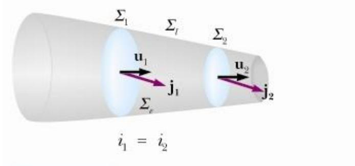
$$\oint_{\Sigma} \vec{j} \cdot d\vec{\Sigma} = \int_{\Sigma_1} \vec{j}_1 \cdot d\vec{\Sigma} + \int_{\Sigma_2} \vec{j}_2 \cdot d\vec{\Sigma} = 0$$
