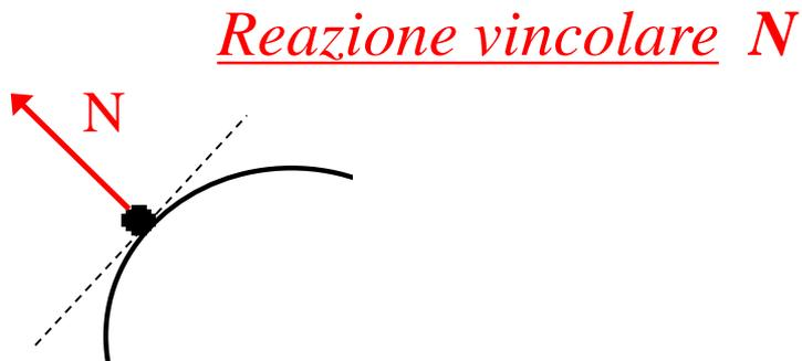
Le reazioni vincolari si manifestano ogni qual volta c'è un vincolo ossia un impedimento al moto del corpo. Può avere una componente normale o parallela al vincolo
