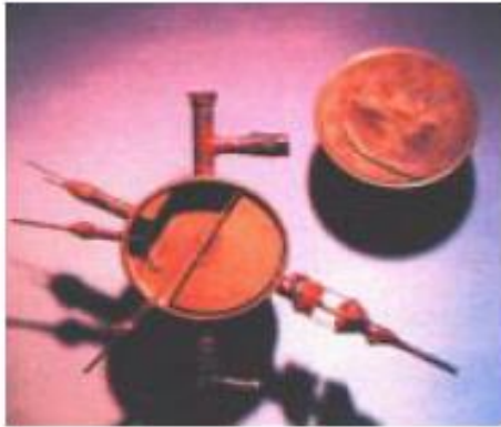
Il primo ciclotrone, sviluppato da Ernest O. Lawrence nel 1929 (Lawrence Berkeley Nat. Lab.) diametro ~10 cm
