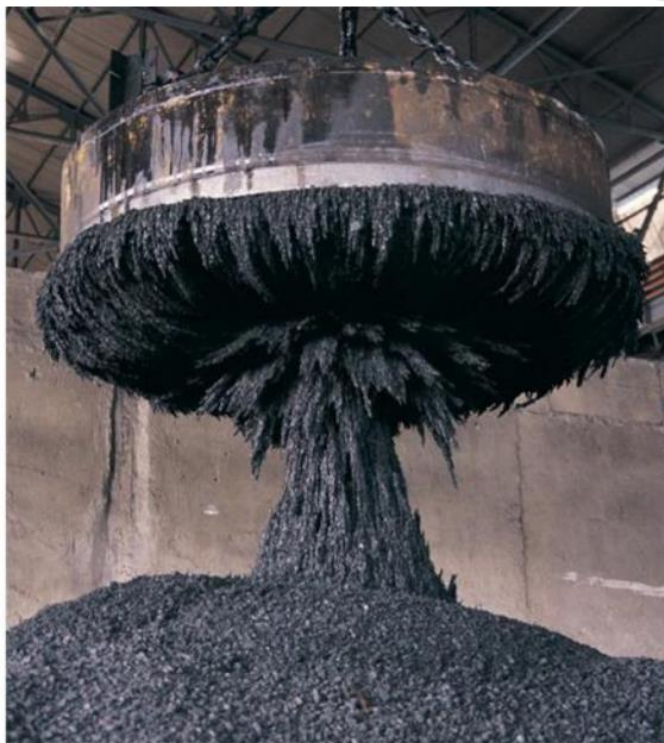
Scorie di ferro raccolte da un magnete in acciaieria
