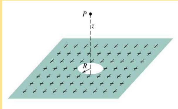
Su una superficie piana isolante molto estesa è distribuita uniformemente una carica con densità  $\sigma$ . Un piccolo foro circolare di raggio  $R$  viene ricavato nel punto centrale del foglio, come mostrato in figura. Si ignori la distorsione delle linee di campo su tutti i bordi e si calcoli il campo elettrico nel punto  $P$ , a una distanza  $z$  dal centro del foro lungo il suo asse.
