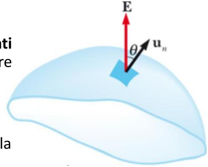
Il **flusso del campo elettrostatico attraverso la superficie  $\Sigma$**  sarà data dalla «**somma**» dei flussi infinitesimi  $d\Phi$  attraverso le superfici  $d\Sigma$
