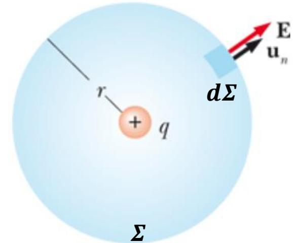
Calcoliamo ora il flusso del campo elettrostatico generato da una carica puntiforme, attraverso una superficie chiusa generica che racchiuda la carica sorgente.
