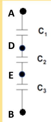
3 condensatori sono collegati in serie con una d.d.p. complessiva ai capi della serie pari a  $V_B - V_A = 100$  V ed una capacità equivalente della serie pari a 100 pF. Calcolare i 3 valori  $C_1$ ,  $C_2$ ,  $C_3$  affinché tra **A** e **D** vi siano 50 V e tra **A** ed **E** vi siano 70 V.
