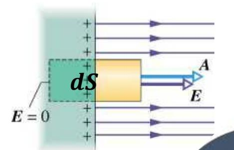
Osserviamo che, se immergiamo **un conduttore**, anche scarico, in un campo elettrico esterno, esso **distorce il campo esterno** in modo in modo che vengano soddisfatte le proprietà elencate, sfruttando la mobilità delle cariche.
