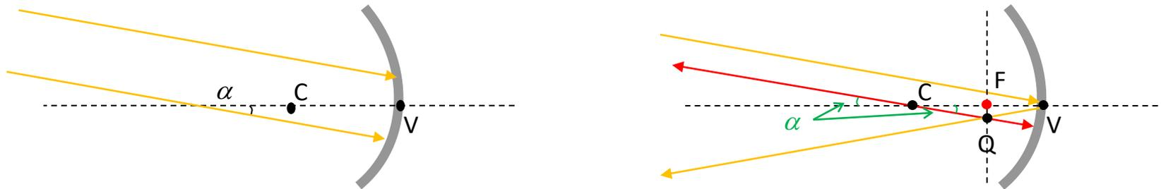
Poiché i raggi provengono dall'infinito l'immagine (punto  $Q$ ), indipendentemente da  $\alpha$  si forma sul piano focale che è il piano perpendicolare all'asse ottico passante per il fuoco  $F$
