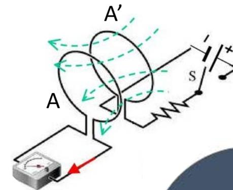
Consideriamo adesso l'esperimento eseguito per la prima volta da Faraday. Una spira A connessa ad un amperometro costituisce il circuito Y, posto vicino al circuito X formato da un solenoide con nucleo di ferro, collegato ad un generatore ed un interruttore.
