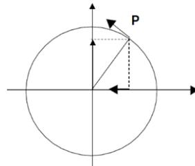
$$\begin{aligned} \text{Infatti: } x(t) = x(t + T) &\Rightarrow A \sin(\omega t + \phi) = A \sin(\omega(t + T) + \phi) \Rightarrow \\ &A \sin(\omega t + \phi) = A \sin(\omega t + \omega T + \phi) \Rightarrow \end{aligned}$$
