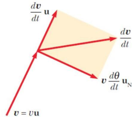
la derivata restituisce due termini: il primo termine  $\frac{dv}{dt} \hat{u}$  è parallelo a  $\vec{v}$  ed è dovuto alla variazione del modulo del vettore, il secondo termine  $v \frac{d\hat{u}}{dt} = v \frac{d\Theta}{dt} \hat{u}_N$  è perpendicolare a  $\vec{v}$  ed è dovuto alla variazione della sua direzione.
